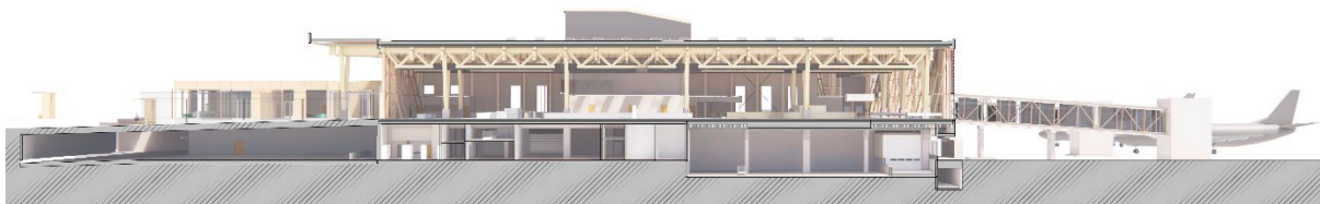
Figur 14: Snitt fra landside med forplass til flyoppstilling
