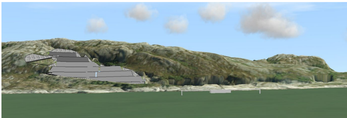
Figur 10: 3D-modell viser utvidelse av bruddet sett fra sjøsiden. Mørk grå farge markerer uttak høyere i terrenget enn dagens uttak. Modellen markerer også ny ytre kai nede til høyre.
