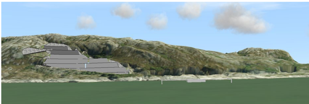
Figur 16: 3D-modell viser utvidelse av bruddet sett fra sjøsiden ca. samme posisjon som Figur 15. Mørk grå farge markerer uttak høyere i terrenget enn dagens uttak. Modellen viser godt utvidelsen av bruddet, men også at det ikke bryter landskapssilhuetten. Modellen markerer også ny ytre kai nede til høyre.
