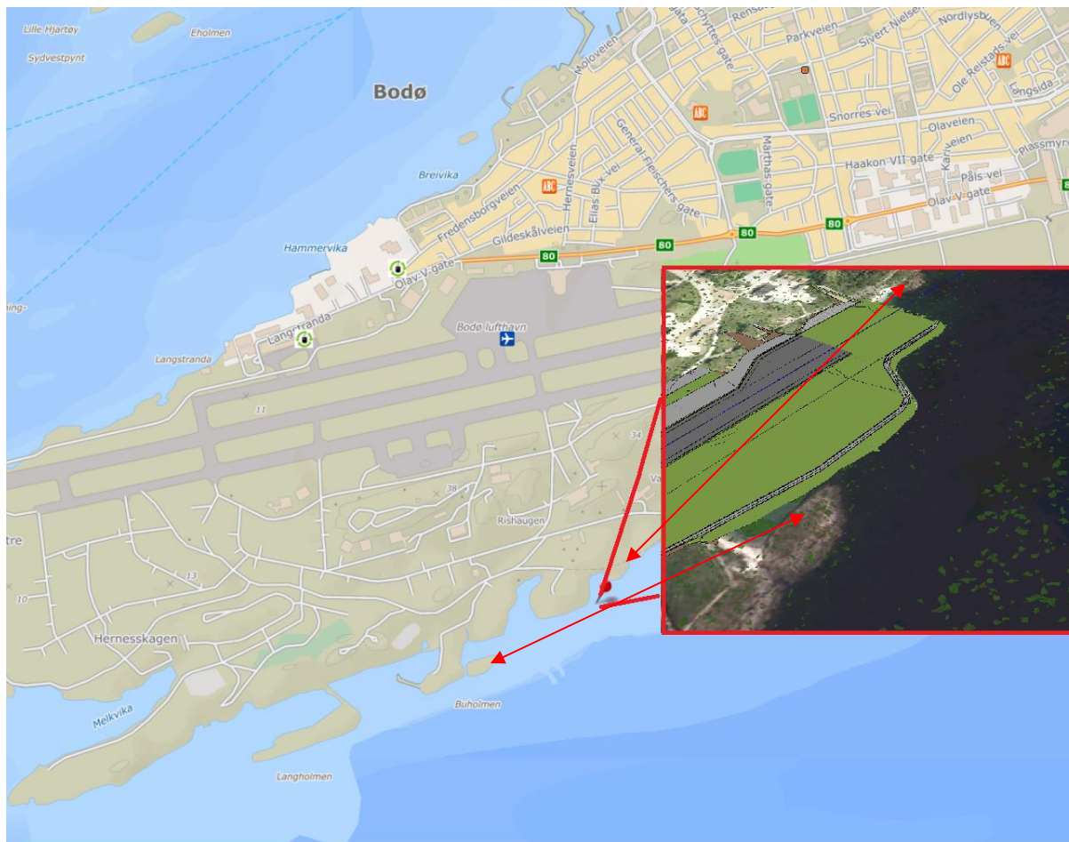
Figur 1: Oversiktskart der ett av de foreløpige fyllingsalternativene (1E) er vist. De røde pilene viser lokaliseringen av bergnabber på kartet.
