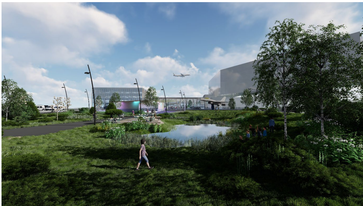
Figur 17: Regnbed – etter krafting nedbør kan det en kort periode stå vann i regnbedet
