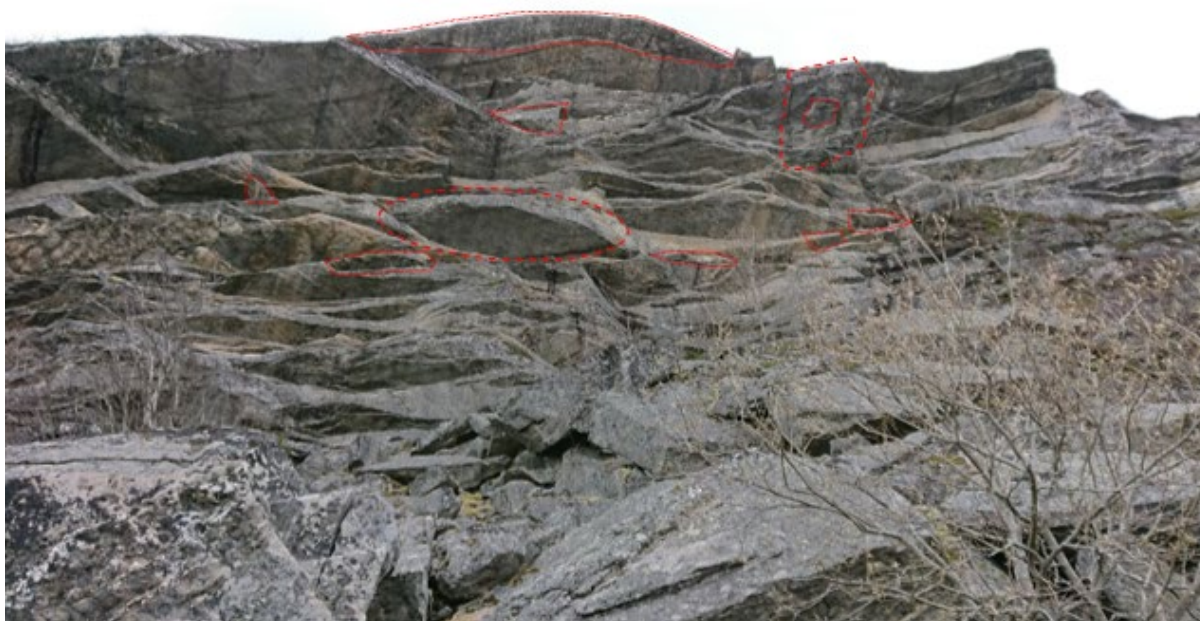
Figur 26: Lokaltet 4 - Potensielt løse blokker er markert
