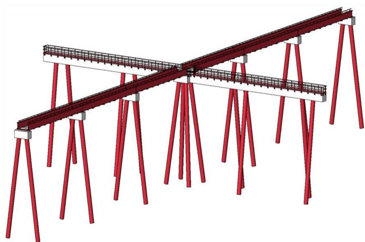
Figur 2: Prinsippskisse av brokonstruksjon for innflygningslys
