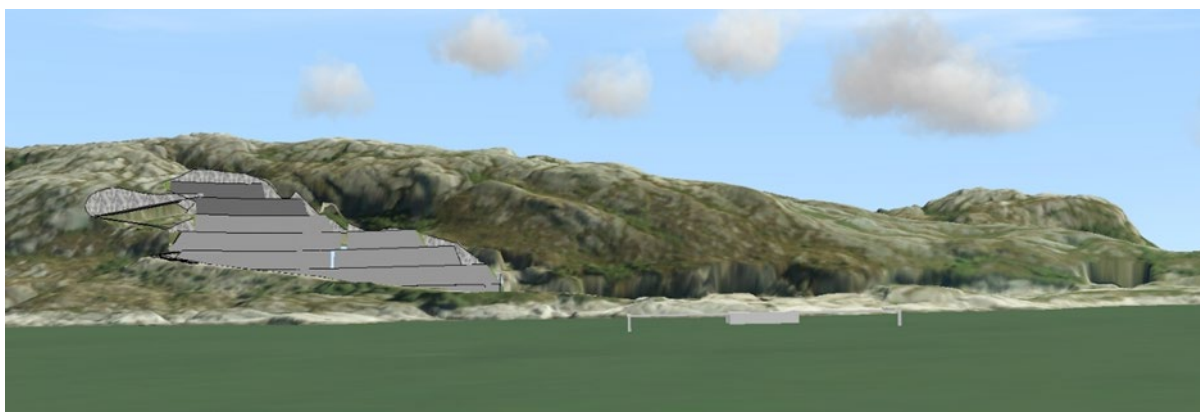
Figur 9: 3D-modell viser utvidelse av bruddet sett fra sjøsiden. Mørk grå farge markerer uttak høyere i terrenget enn dagens uttak. Modellen markerer også ny ytre kai nede til høyre.
