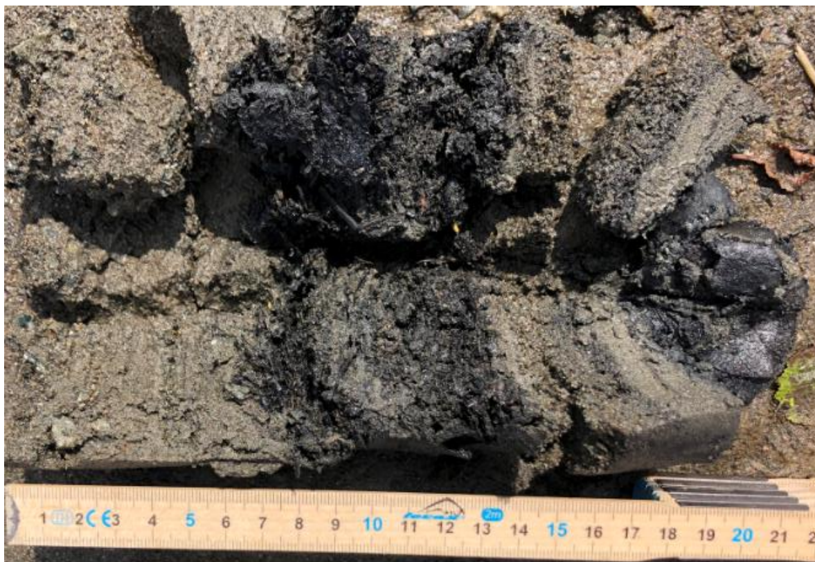
Figur 13 Sedimentkjerne tatt på elvebredd ved ENVA-SE-S4.4 (Sandfærhus). Sedimentet består av distinkte lag med varierende kornstørrelser og organisk materiale (treflis). Dagens overflate er målt fra 0 cm.
