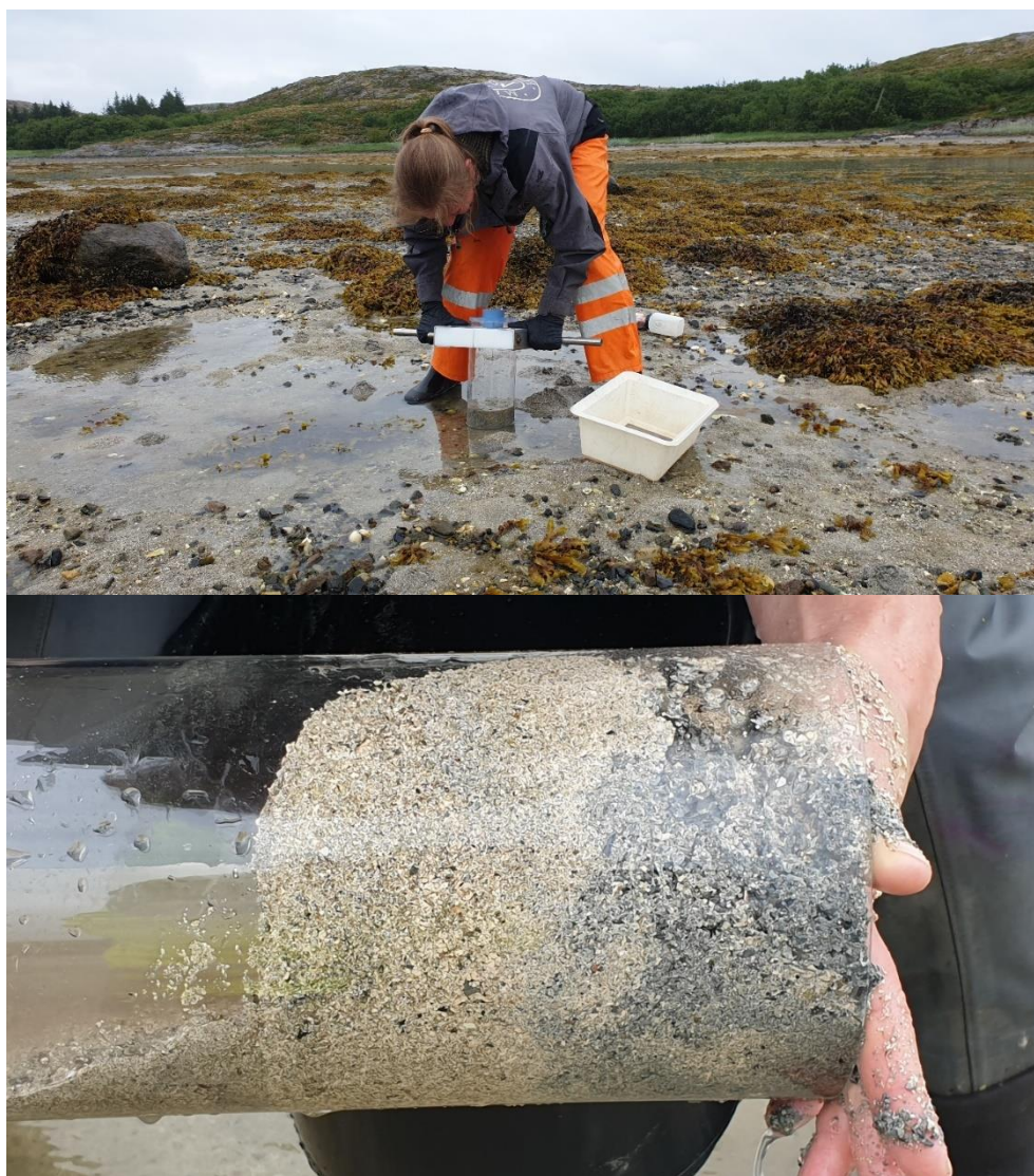
Figur 9 Sylinderprøvetaker for innsamling av infauna i fjæresonen. Det øverste bildet viser prøvetaking, det nederste det innsamlede sedimentet.
