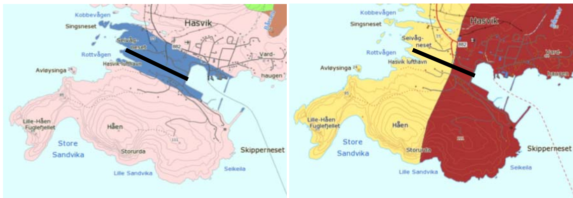
Figur 5. Geologisk kart for lufthavnområdet. Venstre: Løsmassekart: Blå: marin strandavsetning, lys rød: bart fjell, stedvis tynt dekke. Høyre: Berggrunnskart. Rød: gabbro, amfibolitt, gul: metasandstein, glimmerskifer. Kilde: www.ngu.no . Rullebanene er angitt med sort linje.
