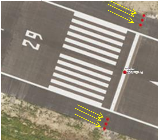
T.v. Nedfelte baneendelys i enden av rullebane 36 på Stavanger lufthavn, Sola T.h. Opphøyde baneendelys i enden av rullebane 11 på Stavanger lufthavn, Sola. Sammenfaller med THR 29
