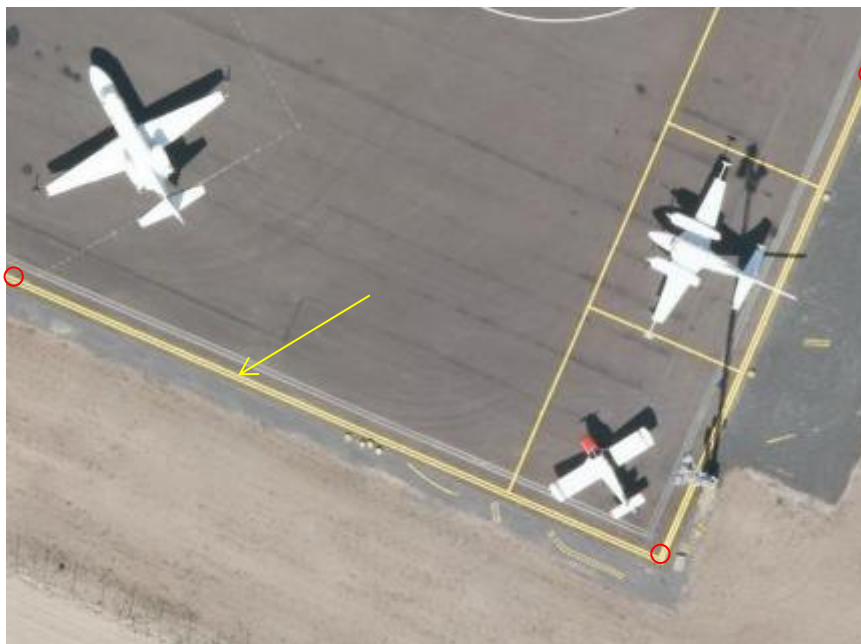
Eksempel på kantmerking (oppstillingsplattform) på Alta lufthavn
