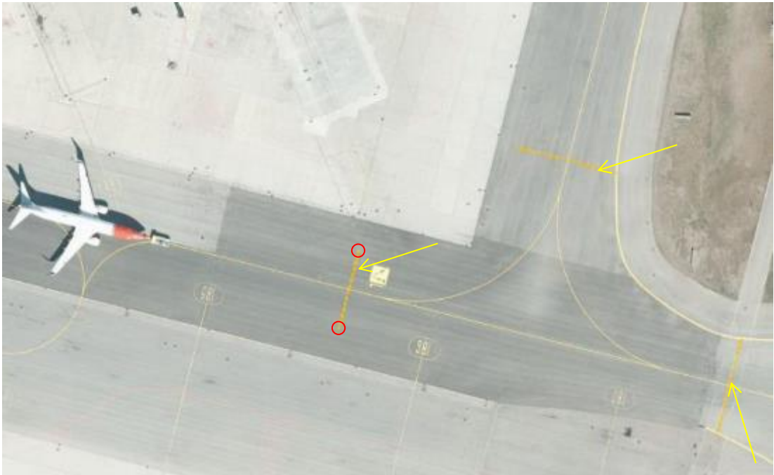
Mellomliggende venteposisjon på Oslo lufthavn, Gardermoen
