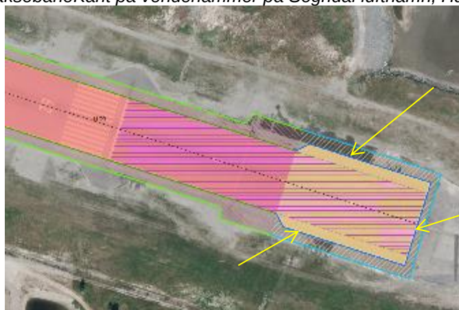
TaksebaneKant på vendehammer på Alta lufthavn
