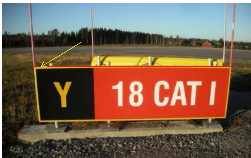
Venteposisjon presisjonsrullebane på Sandefjord lufthavn, Torp
