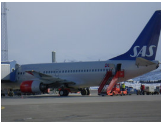
Bruk av bakre dør ved bro
