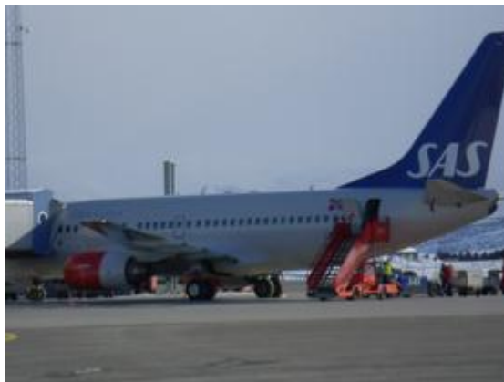
Bruk av bakre dør ved bro
