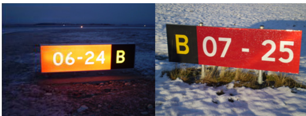
Venteposisjonsskilt for rullebane (opplyst og reflekterende)
